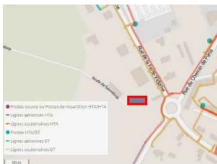
Des **lignes souterraines Basse et Haute Tension** passent à 50m de la centrale. Un poste HTA / BT se situe à 130 mètres de celle-ci.
